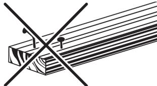
Перед началом работы убедитесь в отсутствии в заготовке металлических предметов (шурупов, гвоздей). Закрепите заготовку так, чтобы она не перемещалась при строгании.
