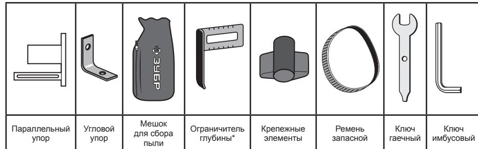
Параллельный упор   Угловой упор   Мешок для сбора пыли   Ограничитель глубины\*   Крепежные элементы   Ремень запасной   Ключ гаечный   Ключ имбусовый
