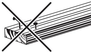
Перед началом работы убедитесь в отсутствии в заготовке металлических предметов (шурупов, гвоздей). Закрепите заготовку так, чтобы она не перемещалась при строгании.
