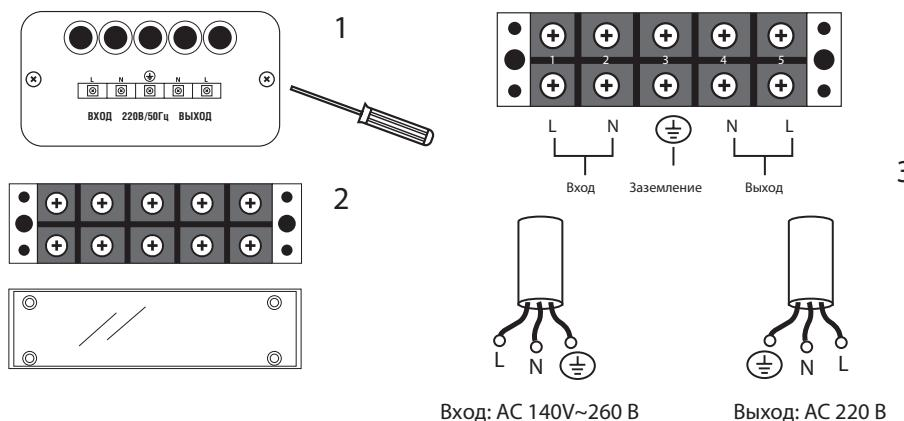
1. Открутите винты и снимите металлическую пластину в нижней части корпуса стабилизатора.
