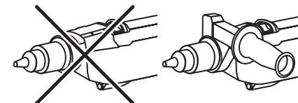
Работа без установленной дополнительной рукоятки ЗАПРЕЩАЕТСЯ
