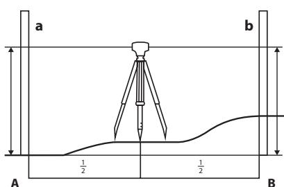
1. Разбейте расстояние на несколько секций и определите превышение для каждой секции.
