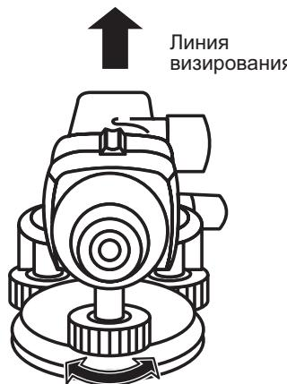
нитей нивелира относительно цели. Нить должна дернуться и вернуться на прежнее место. Рекомендуется проверять поведение компенсатора прибора каждый раз перед началом работы.
