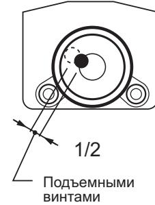
1. Пузырьковый уровень нужен для предварительной установки прибора. Его регулировку надо проводить в специальных условиях.
