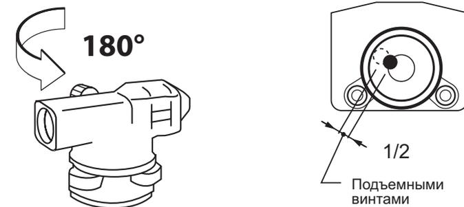
1. Пузырьковый уровень нужен для предварительной установки прибора. Его регулировку надо проводить в специальных условиях.
