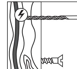
При сверлении отверстий / заворачивании крепежа в стены предварительно убедитесь в отсутствии в данном месте скрытой проводки.
