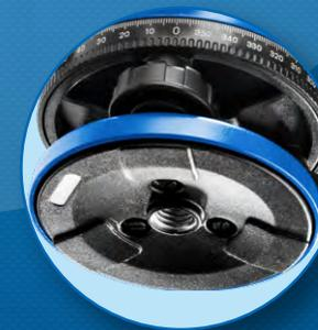
Подставка (трегер) для надежной установки прибора на штатив
