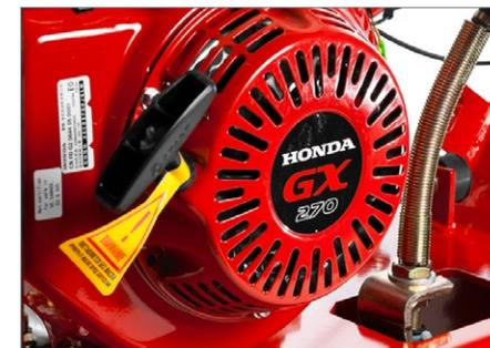
Надежный бензиновый двигатель Honda GX270 мощностью 9 л.с.
