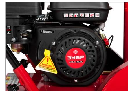
Швонарезчик оснащен бензиновым двигателем ЗУБР РХ180 мощностью 6,5 л.с.
