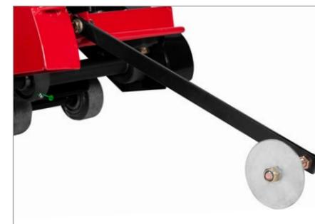
Передняя направляющая служит для точного ведения машины
