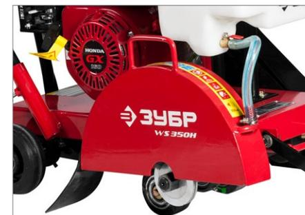
Прочный кожух защищает оператора от пыли и мелких осколков
