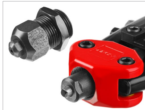
Трехцанговый захват четко фиксирует стержень при монтаже заклепки
