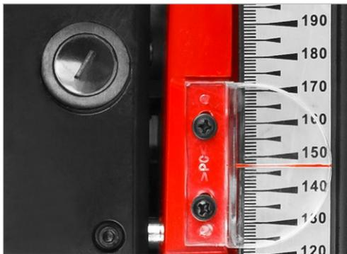
Миллиметровая шкала обеспечивает высокую точность при строгании и избавляет от предварительных замеров
